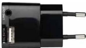
**BTR 011** Bluetooth-Empfänger im Steckergehäuse. Musik kann von Smartphones oder Tablet-PC's kabellos über Bluetooth (Version 2.1, Profil A2DP) an den BTR 011 übertragen werden. Line-Ausgang (3,5 mm Klinke) für den Anschluss zum Beispiel an eine HiFi-Anlage. USB-Anschluss als Ladefunktion. Farbe schwarz glänzend.
