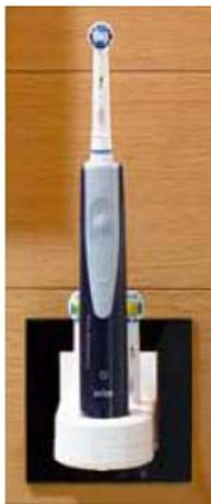
**ZBL 55** Ein innovativer Artikel außerhalb des Audibereichs. Ladestation für elektrische Zahnbürsten für den Einbau in Schalterdosen mit 55 x 55 Maß. Die Zahnbürste ist somit immer griffbereit. Durch den 230 Volt Anschluss kann der ZBL 55 zum Beispiel an Stelle einer Steckdose montiert werden. Erhältlich für die Zahnbürsten Braun Oral B: Professional Care, Vitality, Pulsonic Slim und Philips: Sonicare und die Nacht- Not- und Taschenlampe WHD Jacklight.
