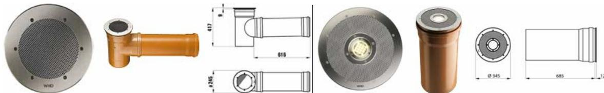
Bodeneinbaulautsprecher (IG 340 zusätzlich mit LED-Orientierungsleuchte 230V) für die Musikwiedergabe im Freien z.B. in Gärten, Außengastronomie, Freizeitparks, ... Das Gehäuse wird oberflächenbündig direkt ins Erdreich eingegraben oder einbetoniert. Die Lautsprechereinheit ist wetterfest, das Lochblech zusätzlich trittfest. Der Anschluss an eine Drainage ist erforderlich.
