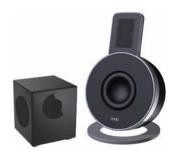
Der S 350 ist ein 2-Wege High End-Designlautsprecher mit Langhub-Basschassis und Bändchenhochtöner. Das Gehäuse des S 350 besteht aus Zink-Druckguss, die Abdeckung des Bändchenhochtöners und das rückseitige Gehäuse aus Aluminium, die Hochtonabdeckung und der Ring um den Tieftöner aus hochwertigem Acrylglas.
