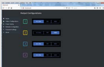
Einstellung der Impedanz bzw. 70/100V pro Zone
