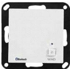
Eingebaut in Standard-Schalterdosen und mit vielen Schalterprogrammen kombinierbar. 230V-Anschluss und integrierter Stereo-Verstärker mit 2 x 1,3 Watt liefert ausreichend Power für mittlere Lautstärken. Der Anschluss nur eines Lautsprechers ist durch den Mono-Schalter möglich.
